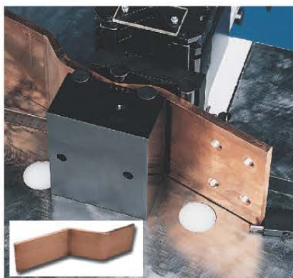
31188 小S雙角折彎，一次完成 最大的加工：銅板寬120 x 厚度10mm 斜坡高差：10-25mm，可調控設定
