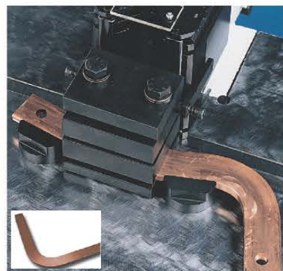
31221 平編模： 銅板寬20-40mm x 厚度10mm，可彎曲 90° 銅板寬50mm x 厚度10mm，只能彎曲 到45° 平編加工最短銅排為250mm
