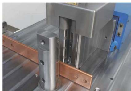
220CNC-plus 折彎以角度或行程輸入自動感測修正工模精度高達±0.1mm, ±0.1°
