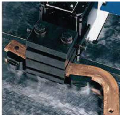
31221 立彎工模 寬20-40mm，最大90度
