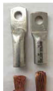
銅管端六角壓接
